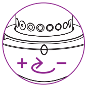
Einstellung des Durchflusses
